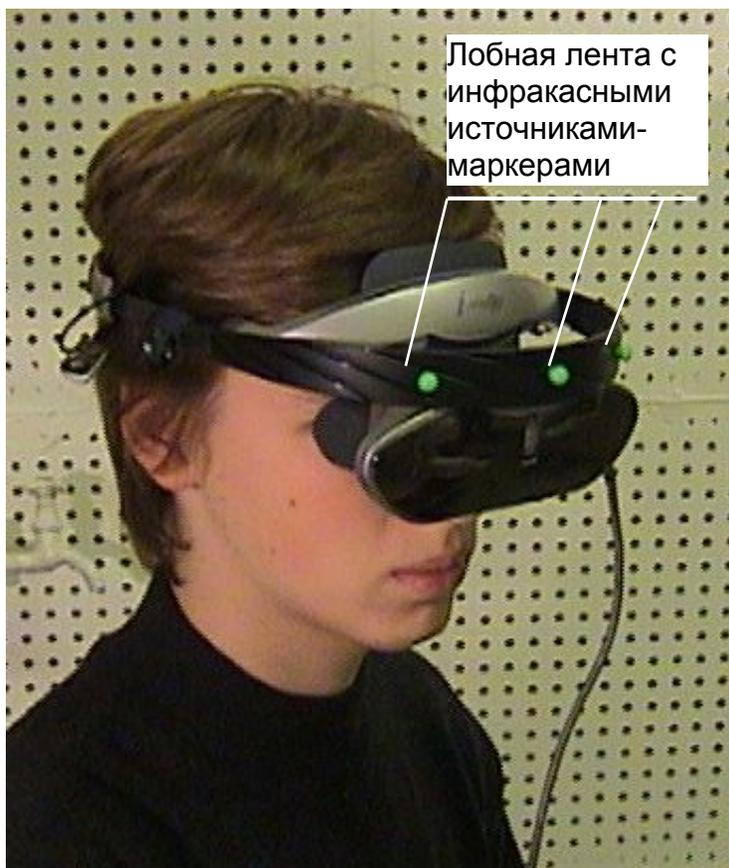
Рис. 8. Лобная лента с инфракрасными источниками-маркерами и микродисплейный модуль типа DH-4400
