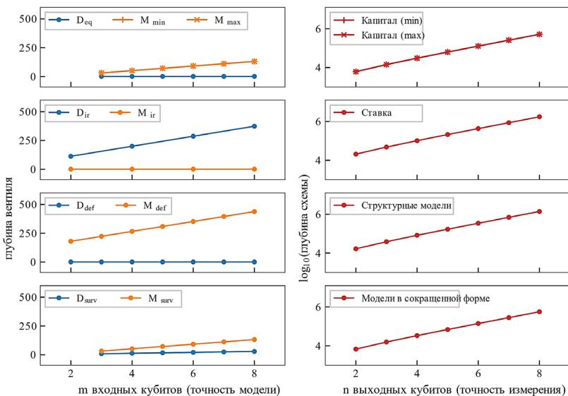
Рис. 18. Левые панели: глубина вентилей  $D$  и  $M$  как функция числа входных кубитов,  $m$ , что представляет точность модели. Правые панели: глубина (в логарифмической шкале) всей квантовой схемы как функция числа выходных кубитов,  $n$ , что представляет точность измерения
