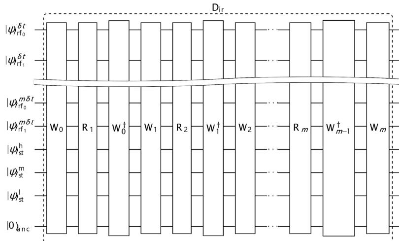
Рис. 12. Вентиль  $D_{ir}$  состоит из последовательности вентилей «чтения» и «записи»
