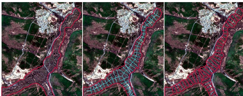
Рис. 3. Алгоритм разделения полигона на части для расчета объема
