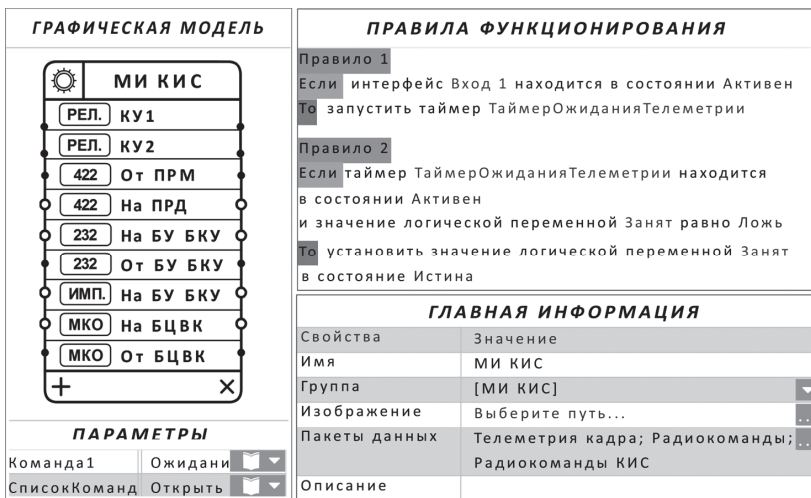
Рис. 6. Пример логической модели командно-измерительной системы
