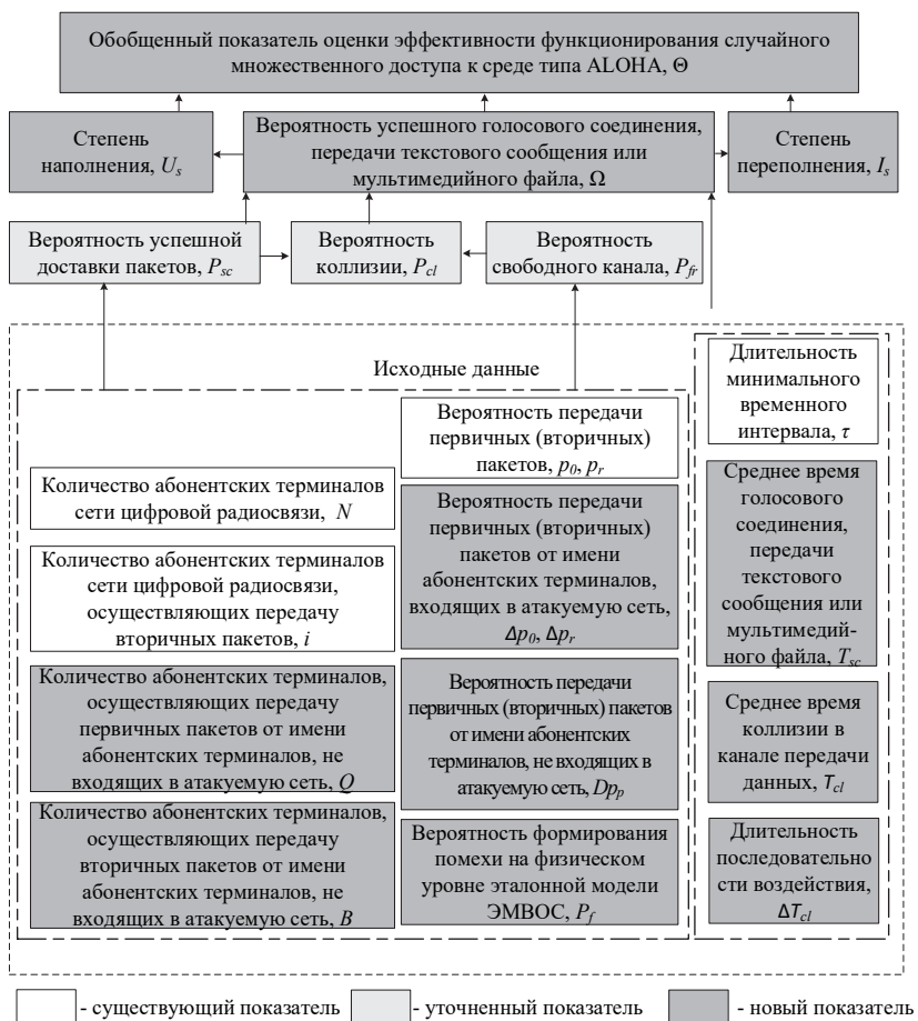
Рис. 7. Система показателей оценки эффективности случайного множественного доступа к среде типа ALOHA сетей цифровой радиосвязи
