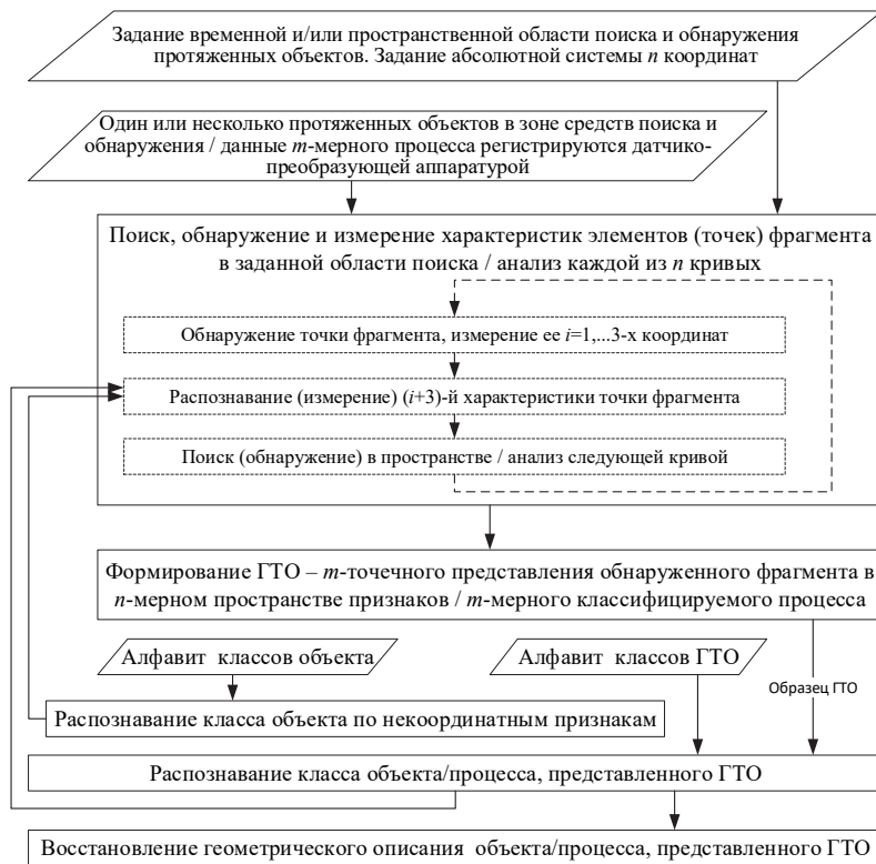
Рис. 6. Циклическая последовательность многоуровневых процессов распознавания на основе координатных и некоординатных признаков объектов и/или процессов
