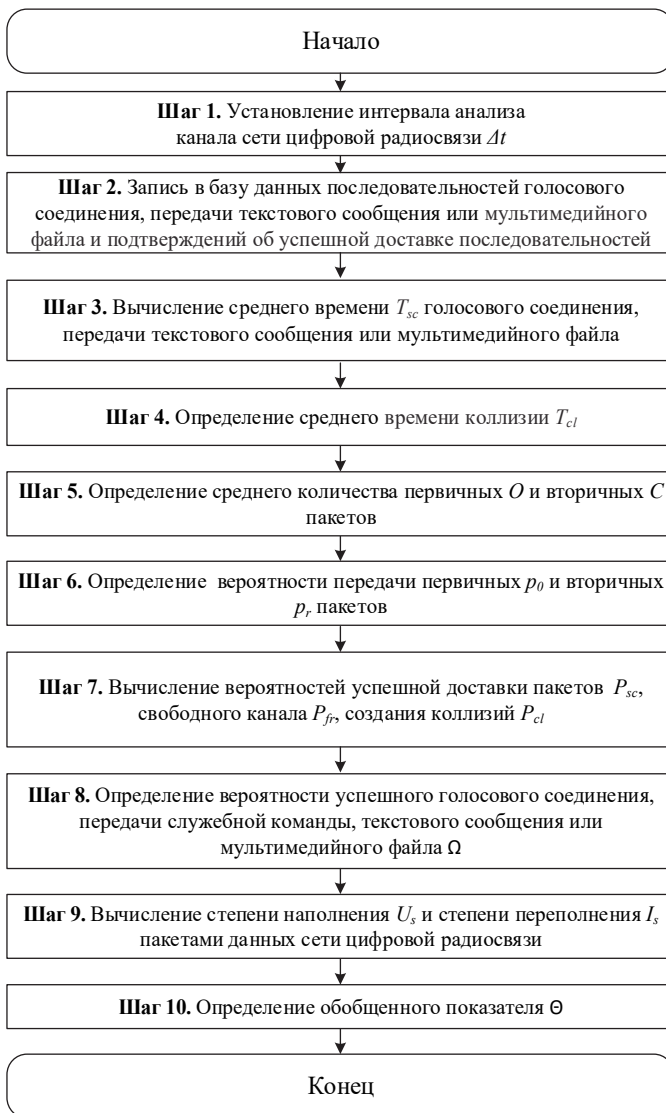
Рис. 8. Методика оценки эффективности функционирования случайного множественного доступа к среде типа ALOHA в условиях деструктивных воздействий
