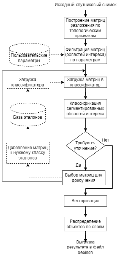
Рис. 11. Общая схема геоинформационной технологии для векторизации областей интереса на спутниковом снимке с помощью матриц разложения. Пунктиром показаны шаги, выполняемые программой в фоновом режиме
