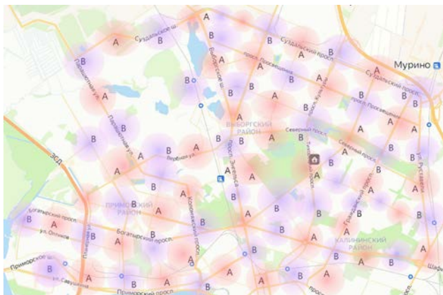
Рис. 6. Вариант формирования решетки транспортных магистралей с двухфазным режимом работы светофоров для организации «тотальной зеленой волны» на примере северных районов Санкт-Петербурга
