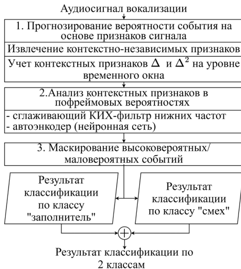
Рис. 7. Схема 3-этапного метода анализа ЭК с учетом контекстных признаков и принятия решения на основе значения вероятности [52]
