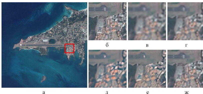
Рис. 5. Примеры восстановления SR фрагментов для набора данных DOTA в четырехкратном увеличении, файл – P4219.png: а) входное HR изображение; б) фрагмент оригинального HR изображения; в) бикубическая интерполяция; г) модель HAUNet; д) модель CALSRN; е) модель ESRGAN; ж) предложенная модель SemESRGAN
