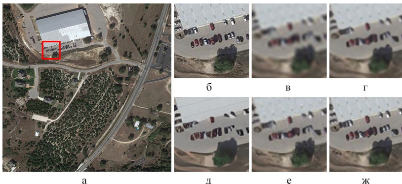
Рис. 6. Примеры восстановления SR фрагментов для набора данных LEVIRCD в четырехкратном увеличении, файл – test_16.png: а) входное HR изображение; б) фрагмент оригинального HR изображения; в) бикубическая интерполяция; г) модель HAUNet; д) модель CALSRN; е) модель ESRRGAN; ж) предложенная модель SemESRRGAN
