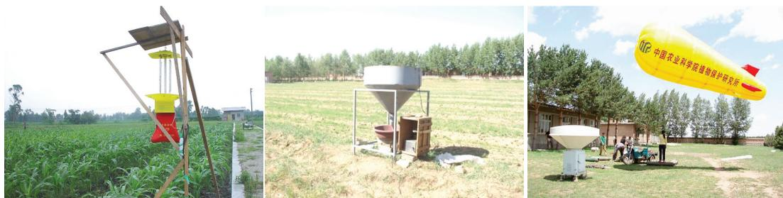
Рис. 3. Оборудование, используемое для диагностики видового состава мигрирующих насекомых (светоловушки наземного базирования и аэростаты).
